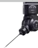
Aplicación del palpador de activación por contacto
